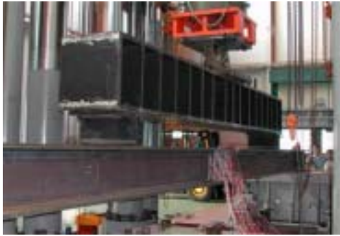
Fig. 2 1000톤 인장시험기를 이용한 고강도강 프리플렉스거더 시험체 재하실험 전경
