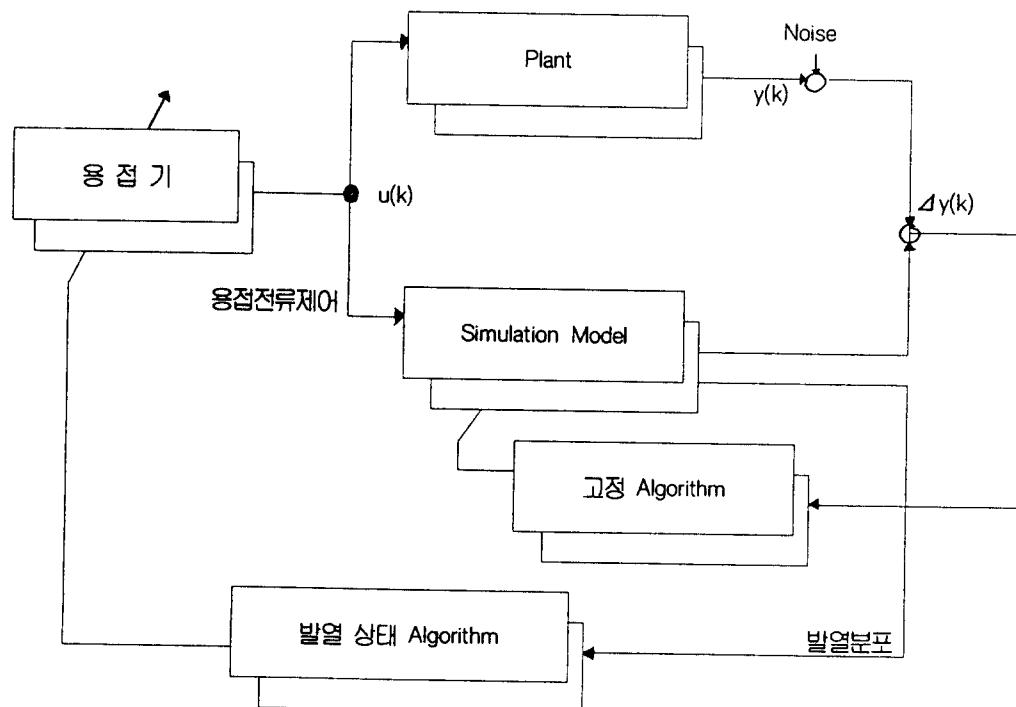
그림 9. Fuzzy 적응 제어 방식의 block diagram
