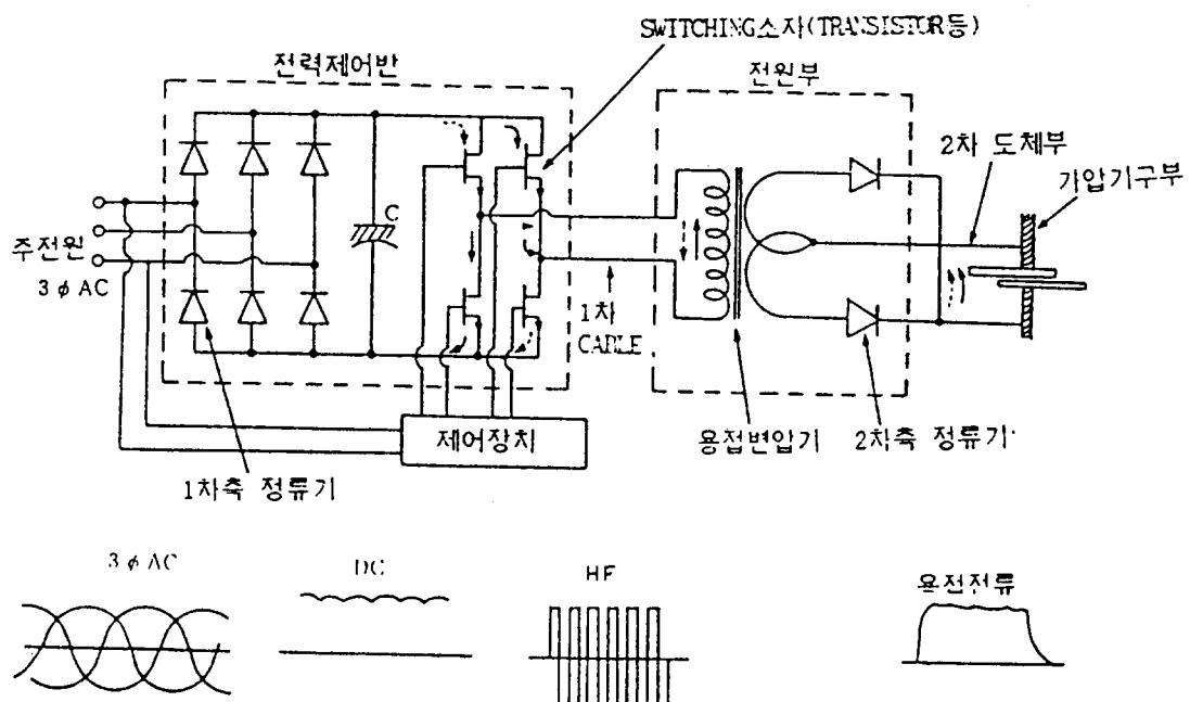
그림 7. Inverter식 직류 spot 용접기의 구성과 전류 과정
