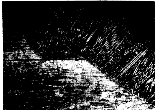
사진 3 Lap 이음부에서의 불균일 용입 현상
