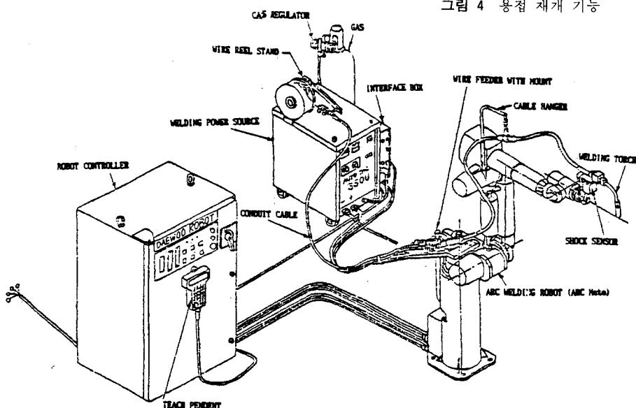
그림 5 아크용접 로보트의 기본 시스템
