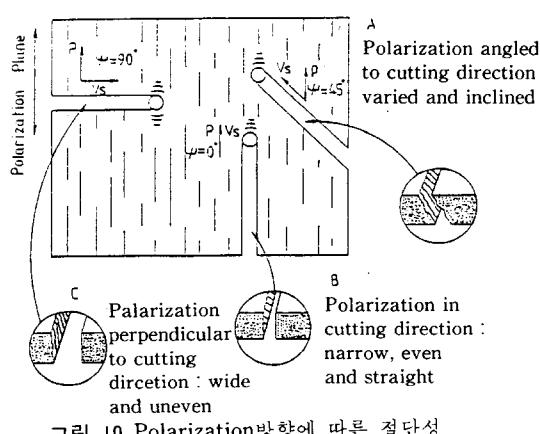
그림 10 Polarization방향에 따른 절단성
