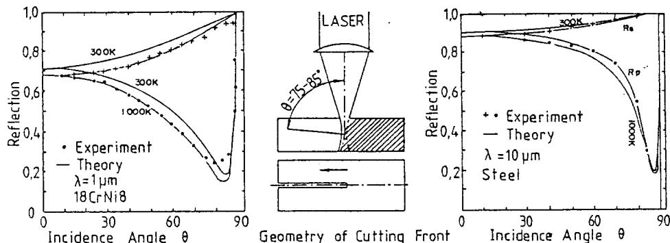
그림 9 a) 입사각에 따른 반사율( $\lambda=1\mu\text{m}$ )
