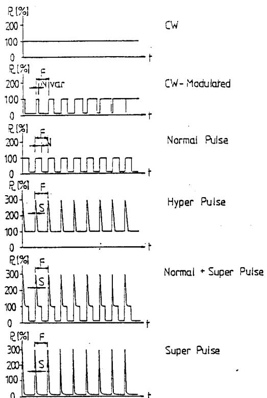
그림 12 Laser 작동방식 (Power modulation)
