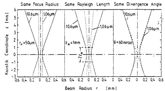
그림 13 CO<sub>2</sub>-Laser beam과 Nd : YAG-Laser beam의 수렴성 비교
