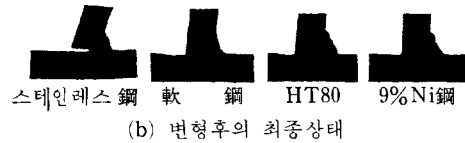
그림 14. 各種 鋼의 T形 試驗片의 용접角變形
