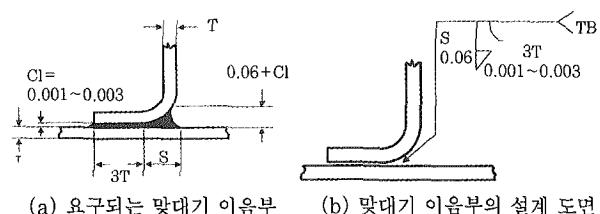
**Fig. 3** 토치 브레이징에서 맞대기 이음부의 설계 시 기호와 표시 위치
