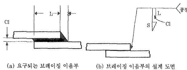
**Fig. 1** 브레이징 이음부의 설계 시 기호와 표시 위치
