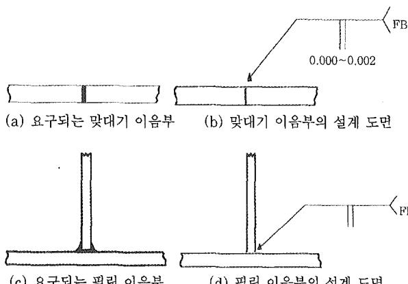
**Fig. 5** 로 브레이징에서 맞대기 이음부 및 필릿 이음부의 설계 시 기호와 표시 위치
