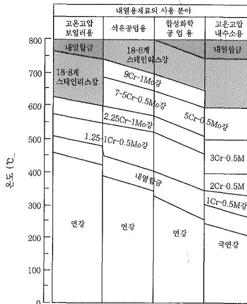
Fig. 1 압력용기 제작에 사용되는 내열강의 용도 및 온도별 사용범위
