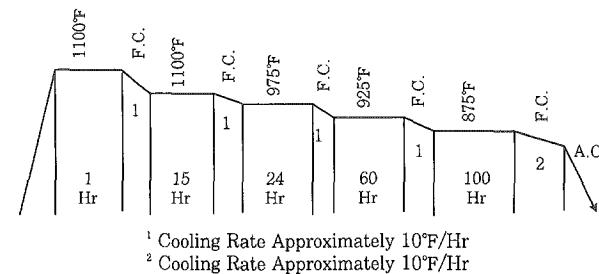
Fig. 4 Step cooling 열처리 과정의 모식도
