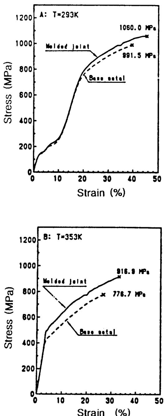
그림 8. Ni-Ti 형상기억합금 마찰압접부의 응력-변형율 곡선
