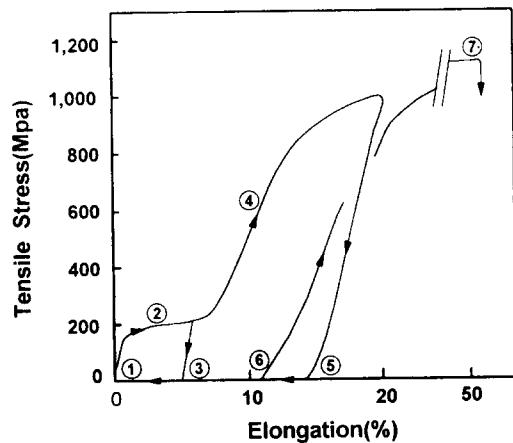
그림 3. 형상기억합금의 전형적인 응력-변형률 곡선
