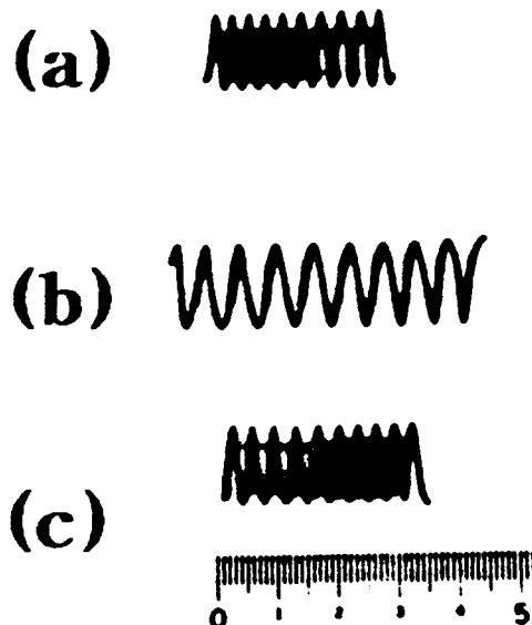
그림 1. Ni-Ti 형상기억합금의 형상기억효과 예
