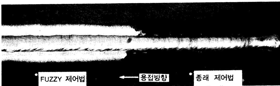
사진 2 알루미늄 MIG 熔接에 있어서 퍼지制御 效果
