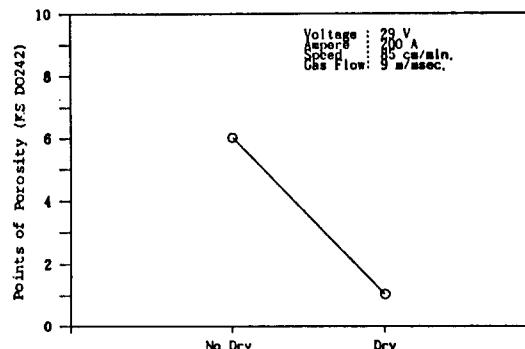
그림 8. 용접 Wire 건조와 기공 발생과의 관계
