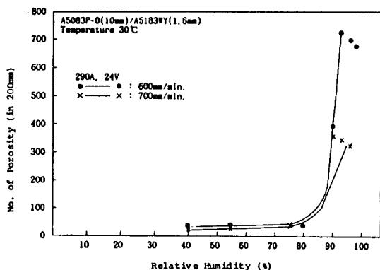
그림 9. 기공 발생수와 대기중의 상대 습도와의 관계
