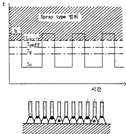
그림 2. Pluse Type 용접전류 및 용적이행 형태
