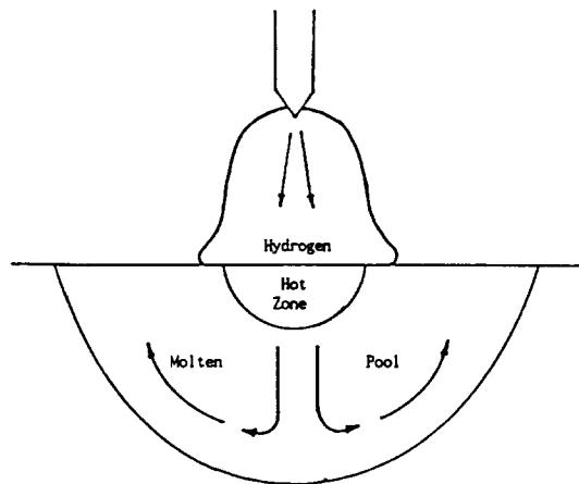
그림 6. Arc 용접시 용융 Pool내의 온도분포의 특징
