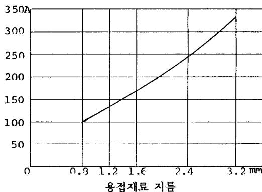
그림 1. Spray Type 용적이행을 얻기 위한 용접 전류
