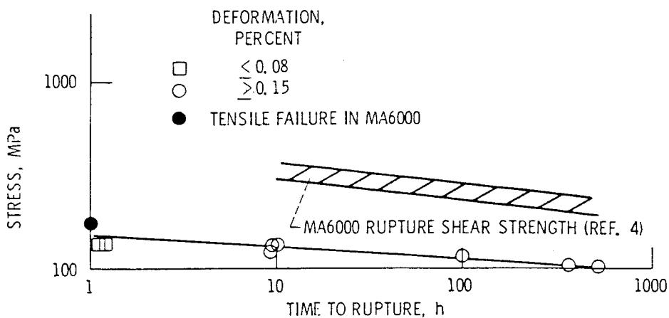
그림 12 MA 6000과 Udimet 700 이재 학산접합 이음부의 760°C에서 creep rupture의 특성
