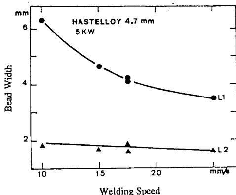
그림 4 Hastelloy X의 내외 bead 폭에 미치는 Laser 용접 속도의 영향
