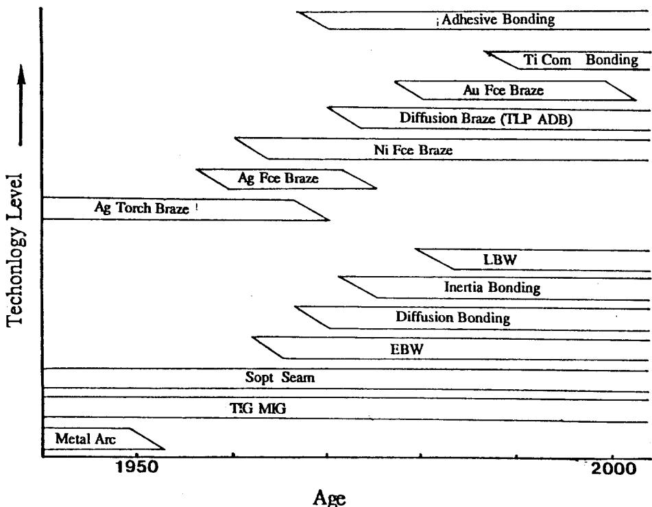
그림 1 Jet Engine의 용접, 접합기술의 추이
