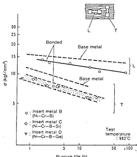
그림 17. MA 754의 액상확산접합 이음부의 creep rupture 특성.
