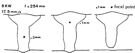
그림 3 Hastelloy X의 bead 형태에 미치는 Laser beam의 초점 위치의 영향
