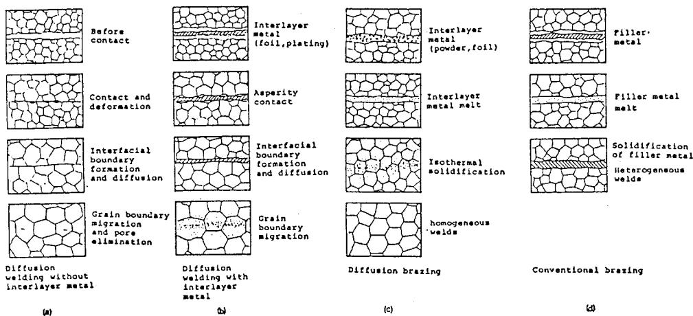
그림 10 확산접합, 액산확산접합, Brazing의 접합과정을 나타내는 모식도
