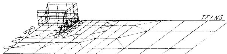
Fig. 25. Top Roll Key 應力解析 Model
